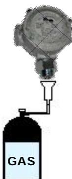
In presenza di gas si leggerà la % rilevata
