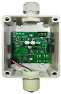
Sonda con Sensore da Sostituire
