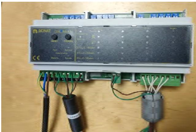
Installez des ferrites dans le câble de signal et les sorties relais conformément au certificat FTZU 23 0078 X. Voir la photo
