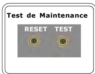
Un appui simultané et prolongé pendant 5 secondes sur les boutons **"TEST"** et **"RESET"** active le mode maintenance.
