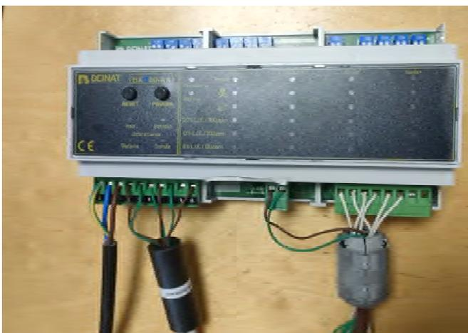
Installare ferriti nel cavo di segnale e nelle uscite relè secondo il certificato FTZU 23 0078 X. Guarda la foto
