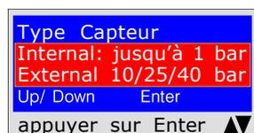
Le programme demande de sélectionner le type de capteur, le capteur doit être sélectionné en fonction du type de pression à mesurer.
