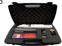
La prova di collaudo generale, e la manutenzione ordinaria o straordinaria **deve essere eseguita ogni sei mesi** emettendo del gas da una bomboletta precalibrata entro le percentuali di targa della sonda.
