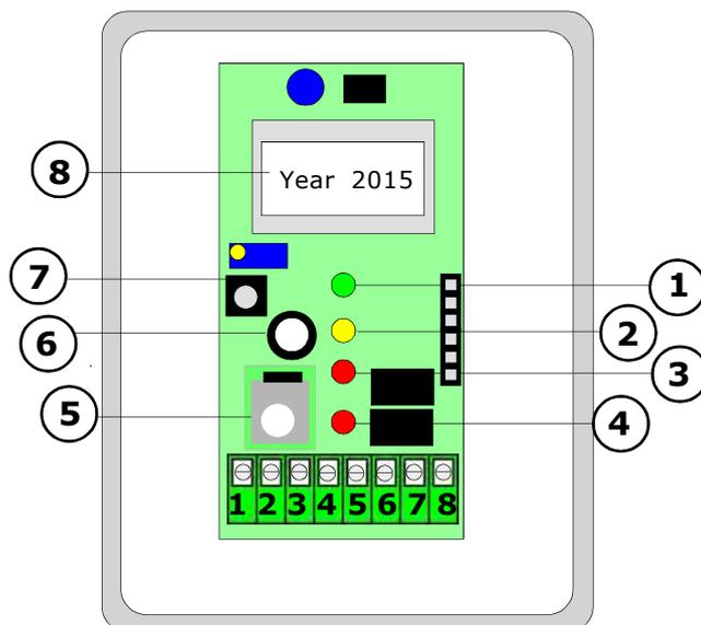
**1)** Led di segnalazione RETE inserita. All'atto dell'accensione il led lampeggia ed effettua un controllo dello stato di efficienza dei sensori di rilevazione gas. Questa fase dura circa 100 secondi trascorsi i quali il led rimane acceso senza lampeggio. **Durante il periodo di test il CHCOind non rileva gas**
