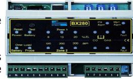
**IMPORTANT:** le test de fonctionnement ne doit pas être effectué avec le robinet de gaz ouvert car cela ne garantit pas une concentration suffisante pour activer l'alarme générale.
