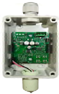
Sonde avec capteur à remplacer
