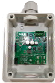
Sonde avec capteur démonté
