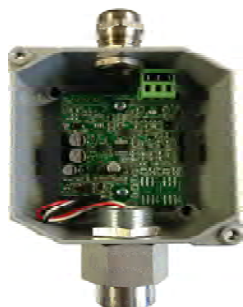
Sonda con Sensore da Sostituire
