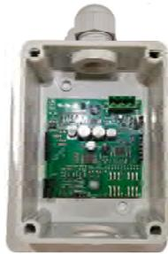
Sonde avec capteur démonté
