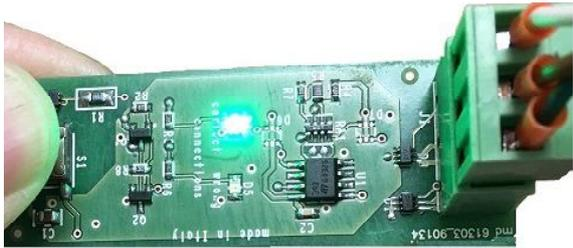
2) Dopo averlo inserito premere il pulsante. Se si accende il **LED Verde**. Significa che il collegamento dei cavi è **ESATTO**. Contemporaneamente la centralina uscirà dallo stato di Avaria e segnalerà lo stato di ALLARME.
