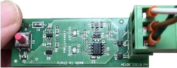
1) Inserire il morsetto collegato al cavo della sonda derivante dalla centralina. Inserirlo nella giusta posizione.
