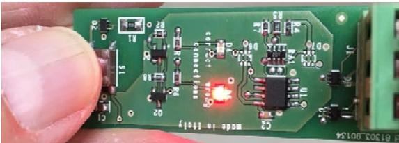
3) Dopo averlo inserito premere il pulsante. Se si accende il **LED Rosso** Significa che il collegamento dei cavi è **ERRATO**. Controllare il collegamento e riprovare. La centralina non segnala nessuno stato di ALLARME, ma segnala lo stato di FAULT.
