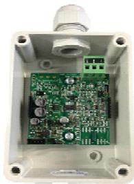
Sonda com sensor Desmontado
