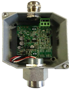
Sonda com Sensor a Substituir
