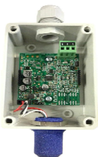
Sonda com sensor a substituir
