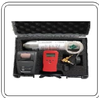
**Teste funcional com GÁS pré-calibrado e testador de controle**
