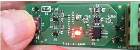
3) Appuyer le bouton après l'avoir connecté. Si le voyant **rouge** s'allume. Cela signifie que la connexion des câbles est **ERRONÉE**. Vérifier la connexion et retenter. La centrale ne signale aucune ALARME, mais elle signale le DÉFAUT
