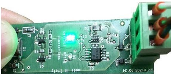
2) Appuyer le bouton après l'avoir connecté. Si le voyant **vert** s'allume. Cela signifie que la connexion des câbles est **EXACTE**. En même temps, la centrale quitte l'état de défaut et signale l'ALARME
