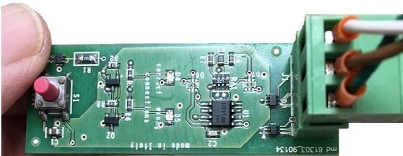
1) Brancher le bornier lié au câble de la sonde provenant de la centrale. Connecter dans la position correcte.
