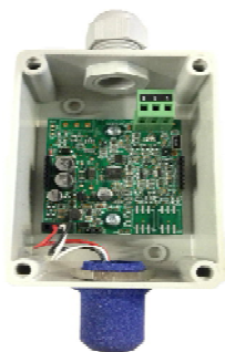
Sonda con Sensore da Sostituire
