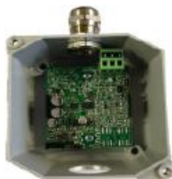
Sonda con Sensore Smontato
