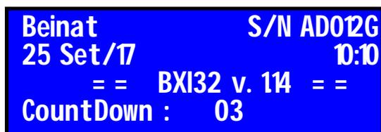
L'afficheur au démarrage de la **BXI32** reste allumé pendant 90 secondes.
