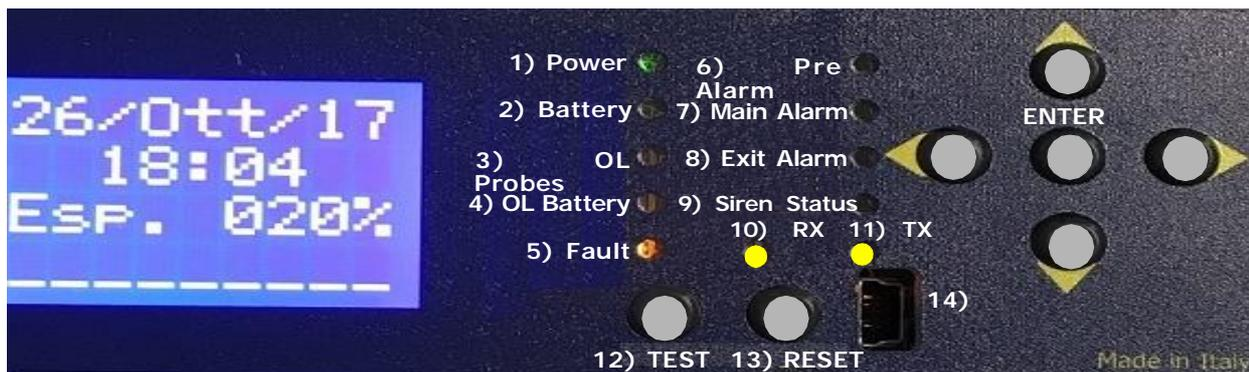
1) **Power** (alimentation). Le voyant LED **verte** de **réseau** s'allume à la mise sous tension.
