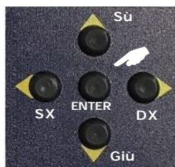
Gruppo di pulsanti di navigazione . Questi pulsanti servono per impostare il funzionamento della centralina.
