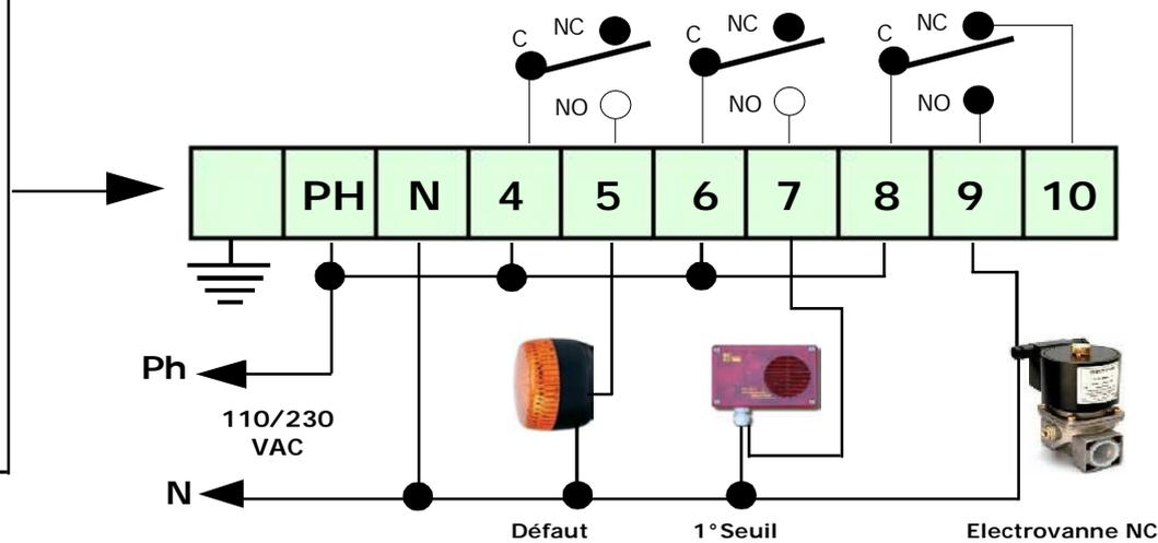
Si une électrovanne 12VDC est connectée à la BX280-AX et elle ne fonctionne pas. La connexion directe d'électrovannes ou de sirènes 12 VDC à la BX280-AX n'est pas possible. Il faut utiliser une alimentation externe. La BX280-AX fournit un courant maximal de 50 mA. **Alimentation de la centrale, connexion d'une électrovanne à sirènes 12 VDC via une source alternative et recharge de la batterie.**
