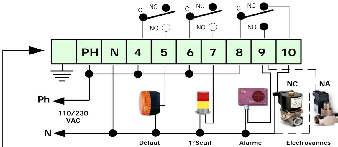
Connexion d'une électrovanne normalement fermée avec la sécurité positive
