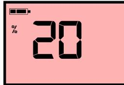
La pantalla roja iluminada la luz intermitente representa un detección de gas en%. Con el aumento de aumentos porcentuales frecuencia de señal Acústico.
