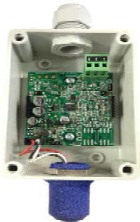
Sonda con sensor a reemplazar
