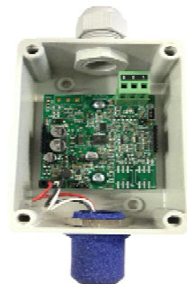
Sonda con sensor Remontado
