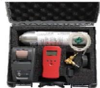
La prueba de control general y el mantenimiento ordinaria o starordinaria **debe efectuarse cada seis meses** emitiendo gas de un pulverizador pre-calibrado dentro de los porcentajes del rango de la sonda.
