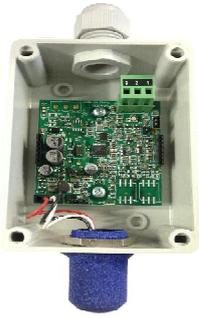
Sonda con sensor a reemplazar
