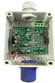
Sonda con sensor Remontado
