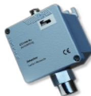
La sonda Convenzionale **SGM595/A** è un'unità di rilevazione gas Catalitica con grado di protezione IP66 che, unita ad una delle centraline di tipo industriale della BEINAT, permette di individuare la presenza di GAS ESPLOSIVI quali : Metano, GPL, e altri tipi di gas, a richiesta.
