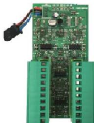
La **CARD-BMS16** è una scheda elettronica di conversione **corrente-tensione**
