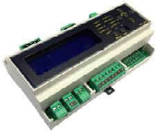
La centralina di termoregolazione **T-REG300** è una apparecchiatura elettronica che, basandosi sull'esperienza pluriennale della **BEINAT S.r.l.** nel settore della termoregolazione, consente di mantenere sotto preciso controllo la temperatura di riscaldamento negli ambienti.
