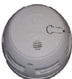
Questo rilevatore d'incendio consente la rilevazione di un incendio captando la presenza di fumo, bianco da carta o nero da gomma, e di attivare l'allarme senza l'ausilio di una centralina, perché ha a bordo un relé di comunicazione. Funziona con una batteria a 9 V.
