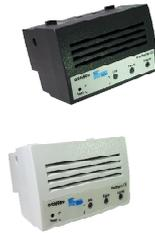
Il rilevatore **GSH900**, tramite il sensore **Catalitico**, rileva la presenza di gas Esplosivi quali: METANO e GPL, con una sensibilità di intervento tarata al 10% del **Limite Inferiore di Esplosività**.
