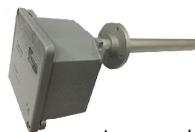
La sonda **Convenzionale AUTONOMA** con controllo di avaria è un'unità di rilevazione gas Catalitica con grado di protezione IP66 in grado di individuare la presenza di **GAS ESPLOSIVI** quali : Metano, GPL, e Idrogeno. La sonda viene gestita da un microprocessore che oltre a fornire un segnale d'allarme alla centrale a cui è collegata, permette di fare una auto diagnosi, e quindi una **TARATURA AUTOMATICA**.
