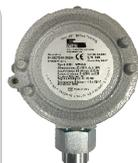
La sonda Convenzionale **SG580** è un'unità di rilevazione gas Catalitica con grado di protezione Antideflagrante IP66 **non Certificata ATEX** che, unita ad una delle centraline di tipo industriale della BEINAT, permette di individuare la presenza di GAS ESPLOSIVI quali : Metano, GPL, e Idrogeno
