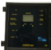
La centrale **BX444-Mc** è stata costruita secondo la Normativa Europea per verificare in modo versatile, grazie alla possibilità di collegare da **1 a 4 sonde** Catalitiche oppure Elettrochimiche, con **rilevamento da 4 - 20 mA**, a distanza, la presenza di **gas tossici e/o esplosivi, e Ossigeno**
