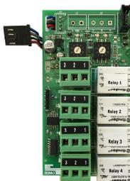
La **CARD-RLS4** è una scheda elettronica di espansione relé. Collegata alla centralina permette di comandare indistintamente 4 relé. Le CARD-RLS4 possono essere multiple fino ad un massimo di 16, raggiungendo un massimo di 64 relé.
