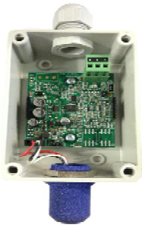
Sonda con Sensore da Sostituire
