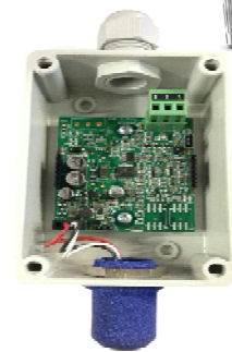
Sonde avec capteur remonté
