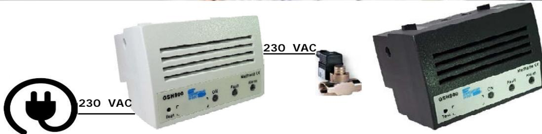
Le détecteur **GSH900** grâce au capteur **catalytique**, détecte la présence de **gaz explosifs** tels que le Méthane et GPL, avec une sensibilité d'intervention étalonnée à 10% de la Limite Inférieure d'Explosivité. (L.I.E.)
