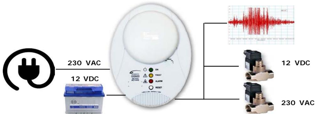
Le **GS920** est un détecteur de gaz de haute technologie avec «**intervention sismique**» et la possibilité de sélectionner le **contrôle de la sécurité positive**.
