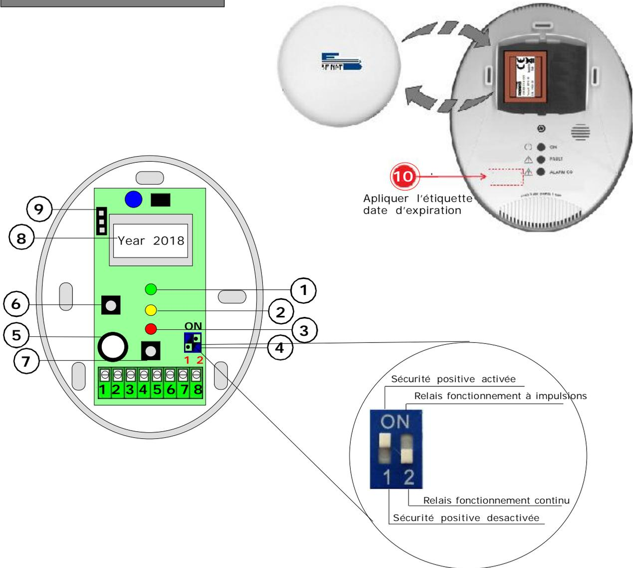
1) Le voyant Led vert de RÉSEAU. À la mise sous tension le led vert clignote et le détecteur effectue un contrôle de l'efficacité du capteur de détection gaz. Cette phase (démarrage) dure environ 60 secondes après quoi le led arrête de clignoter.
