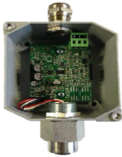
Sonda con Sensore da Sostituire
