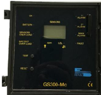
La Centralita **GS300-Mc** ha sido diseñada y construida según normativa europea para verificar de manera versátil, gracias a la posibilidad de conectar de 1 a 3 sondas a distancia, la presencia de gases **explosivos y/o tóxicos**.
