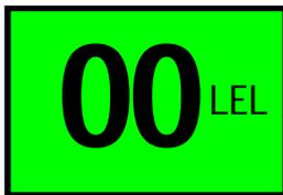
La pantalla color verde muestra una ausencia de fuga de gas. condición normal.
