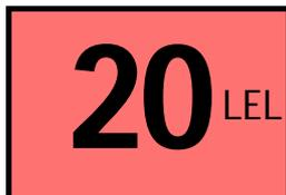
La pantalla con color rojo muestra una concentración de gas explosivo en % de LEL (L.I.E.) superior a un de umbral de alarma.
